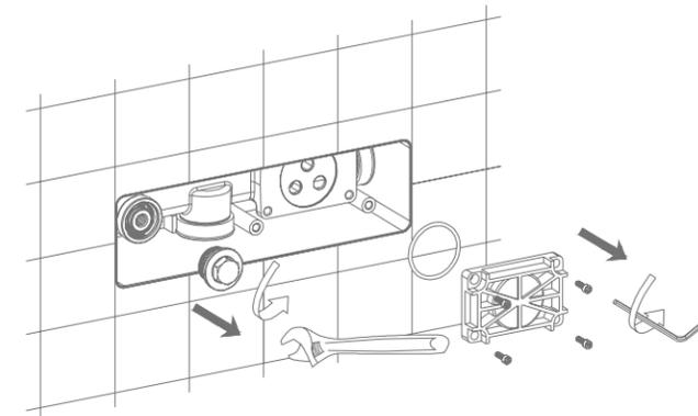
拆除试水板、试水接头
