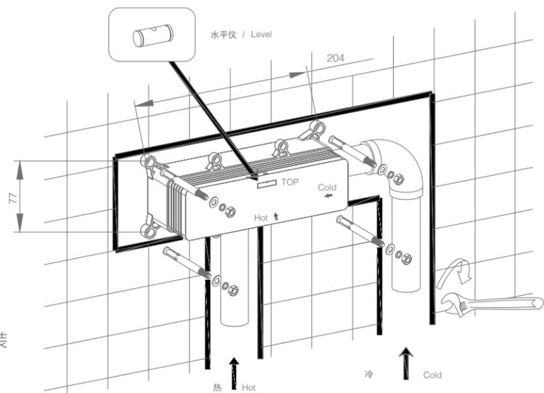
观察水平仪，确保水平安装
