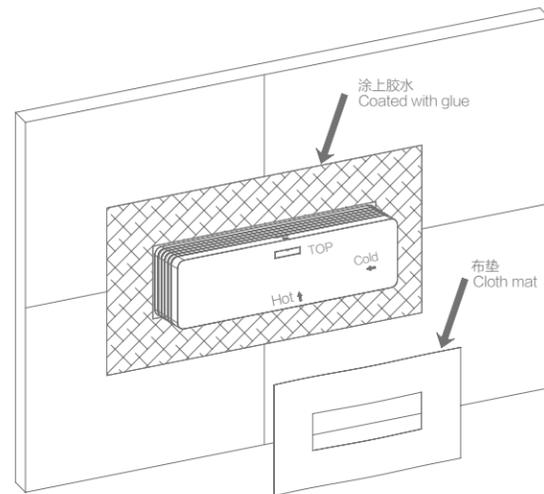
贴墙面瓷砖前，在预埋盒周边涂上一层胶水，然后帖上布垫，再帖瓷砖，这将便于换修时拆装墙面。
