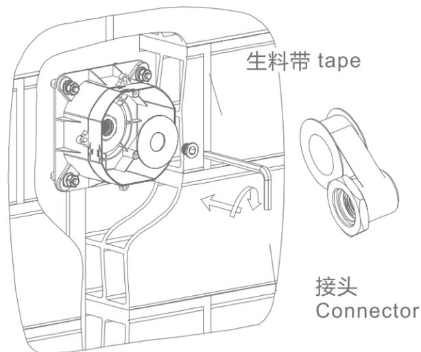
先把垫片放进预埋座内, 固定好, 用生料带把接头螺纹缠好 (注意接头孔位), 用六角匙将接头旋进预埋座中间的孔位。
