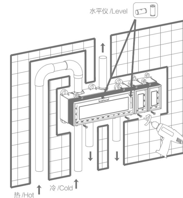
观察水平仪，确保水平安装
