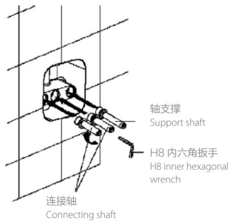
按图示依次拧紧连接轴和支撑轴。
