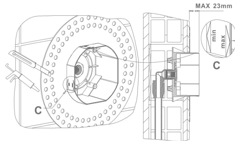
贴墙面瓷砖前，在预埋盒周围图上一层胶水，然后贴上布垫，再贴上瓷砖，这将便于换修时拆装墙面，将高出墙面部分的预埋盒切除，在预埋盒周边打上密封胶，增强盒子于墙面的密封性。
