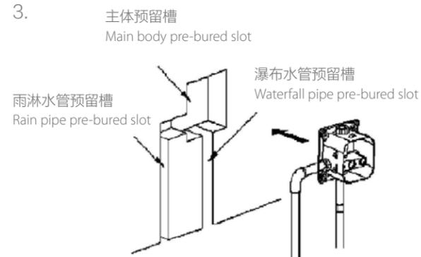
双功能预埋：根据产品实际尺寸，参照上图开墙开挖主预埋槽、雨水管预埋槽、瀑布管预埋槽。
