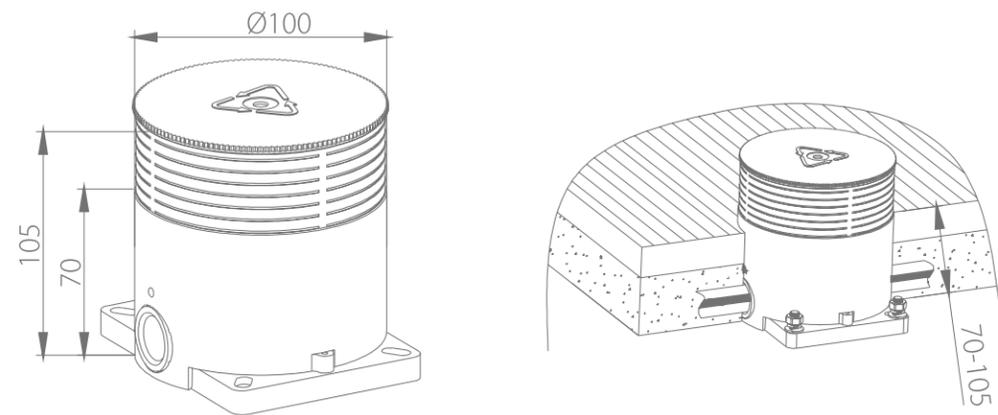
填埋深度 70-105mm(含地砖), 适当升降毛坯地面高度
