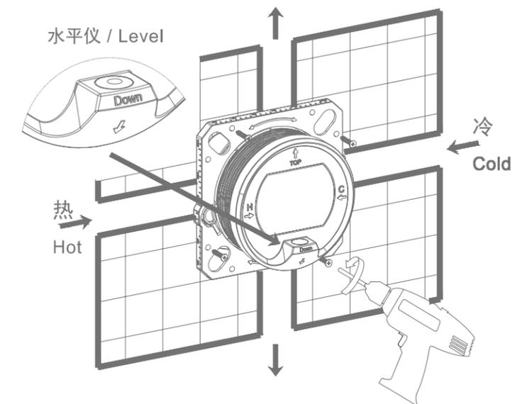
观察水平仪，确保水平安装
