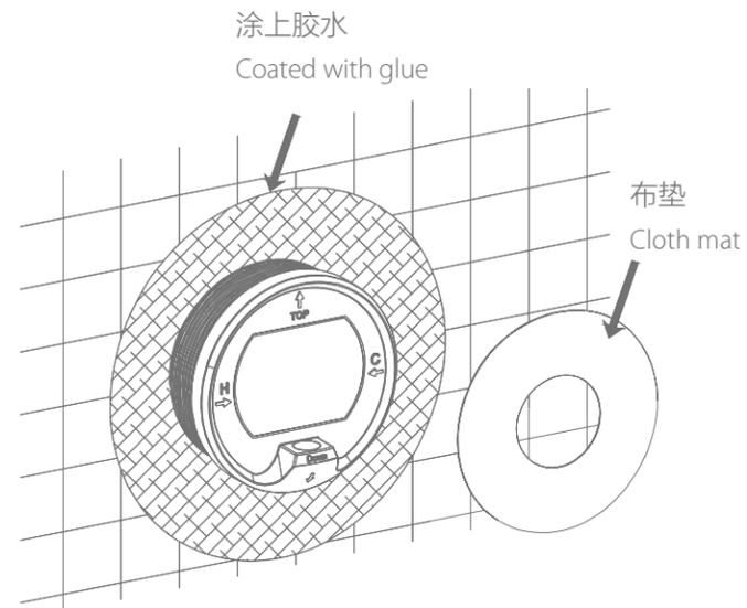
贴墙面瓷砖前，在预埋盒周边涂上一层胶水，然后帖上布垫，再帖瓷砖，这将方便于换修时拆装墙面
