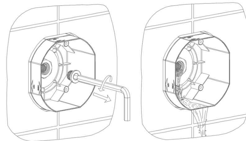
封好水泥后, 把预埋座中间的接头旋出来, 打开水龙头开关, 把管道中的杂物冲洗干净
