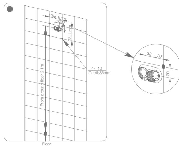
根据图纸，用铅笔和直尺在墙上画一些点，用直径 10mm 的钻头钻一个深度为 85mm 的孔。
