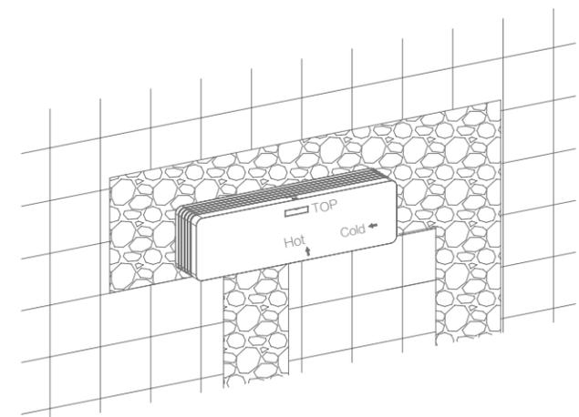
A. 面盆龙头预埋盒安装（分离式） | 空心墙体安装 HOLLOW WALL INSTALLATION
