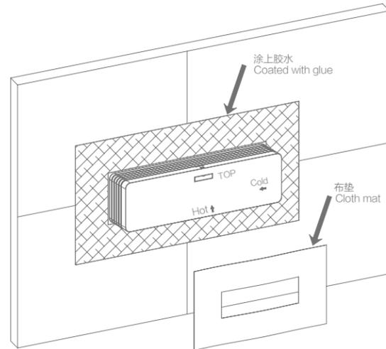
贴墙面瓷砖前，在预埋盒周边涂上一层胶水，然后贴上布垫，再贴瓷砖，这将便于换修时拆装墙面。
