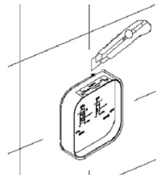
淋浴部分可通过切割预埋箱高出墙面的边缘部分来安装。
