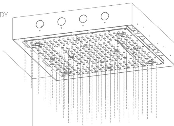
①连接好软管后，打开开关阀，让产品处于正常使用状态，观察软管接头处，确保各软管接头无漏水现象
