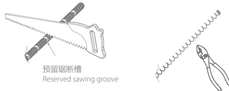
拉杆螺丝的原长度 300mm，要调节至比墙面天花板与预安装天花板之间的距离 H 略小 ( 不能超过 300mm )，超出的长度在螺丝槽中用钢锯锯掉，弹簧也要缩短相应的尺寸。
