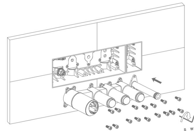
将暗装阀与控制阀对准孔位用螺丝固定
