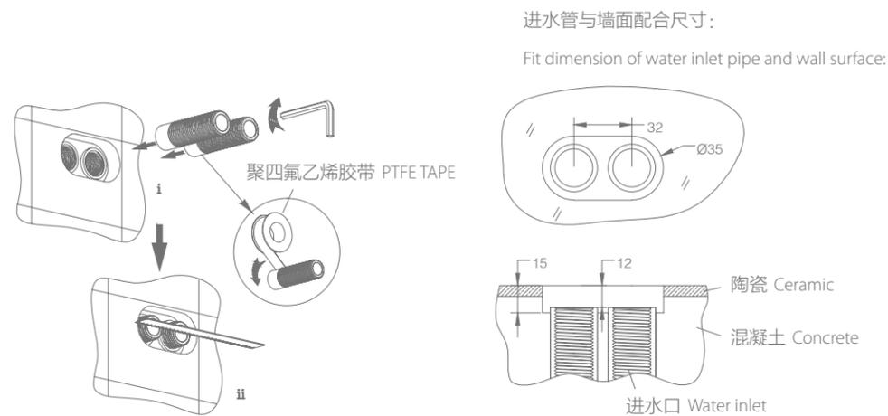
按图要求取填料内 G1/2 接头安装。
