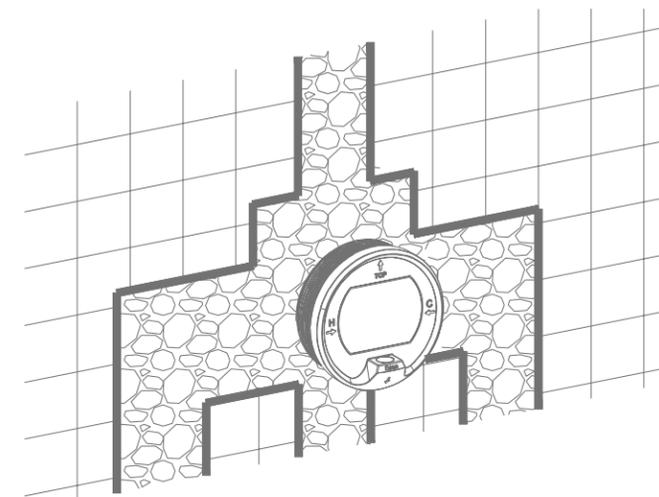
密封性测试完成后, 用水泥填料将预埋开口及管道进行封填
