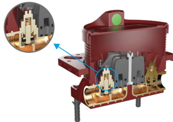
弹簧止回设计，防止冷热水互串、防止水逆流；旋转停止设计，方便安装测试与维修
