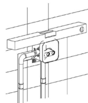
安装预埋箱，用水平尺测量预埋箱壳的水平度，调整预埋箱，确保预埋箱与垂直墙的夹角接近理想的 90 度角或略向上翘曲。
