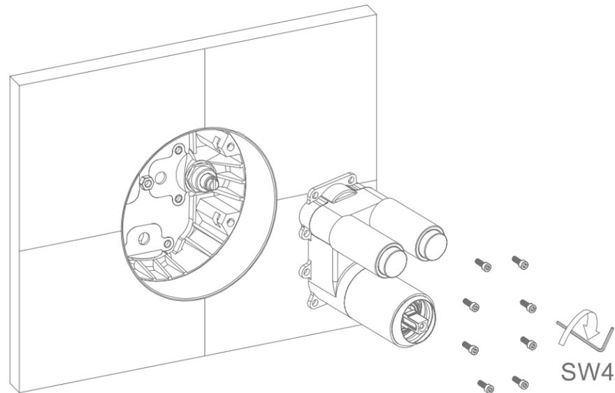
将暗装阀与控制阀对准孔位用螺丝固
