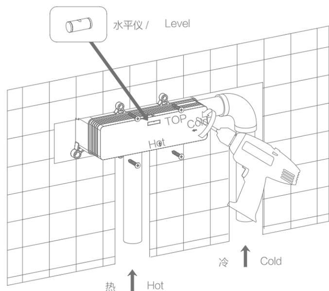
观察水平仪，确保水平安装
