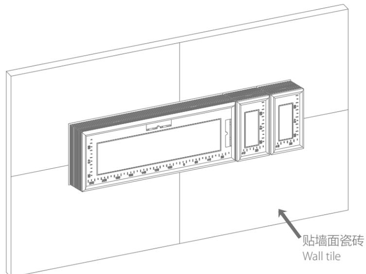
C. 控制阀安装 CONTROL VALVE INSTALLATION
