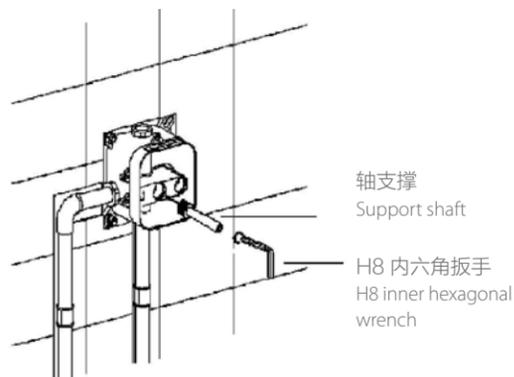
用支撑轴堵住瀑布，打开瀑布水源，检查各处密封情况和压力情况，确保无泄漏。
