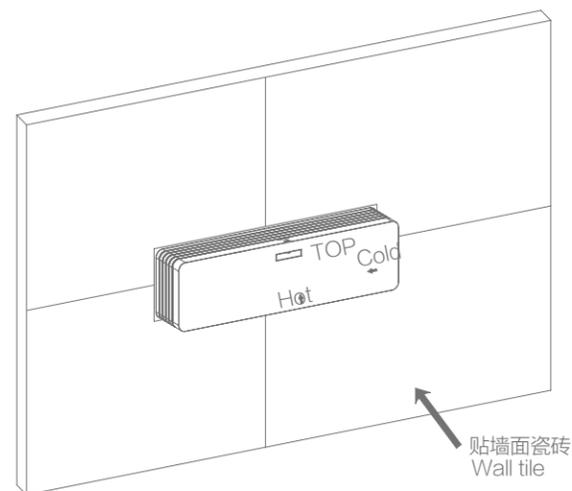
C. 控制阀体安装 CONTROL VALVE BODY INSTALLATION
