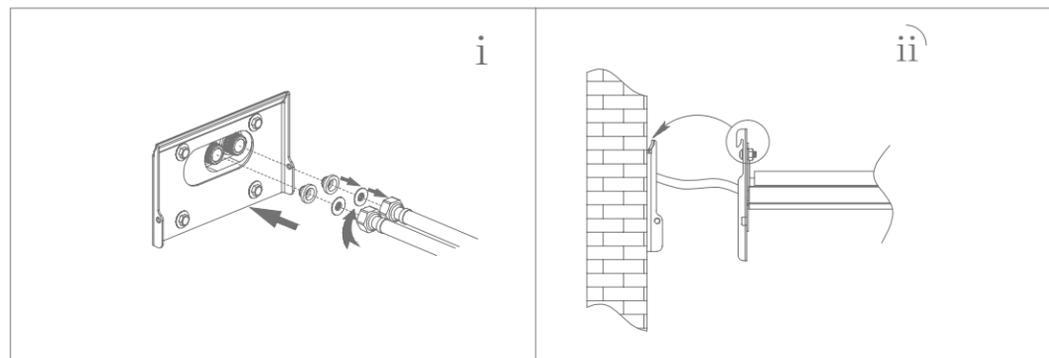
①将凸面节水阀放入填料内，放入进水管接头。
