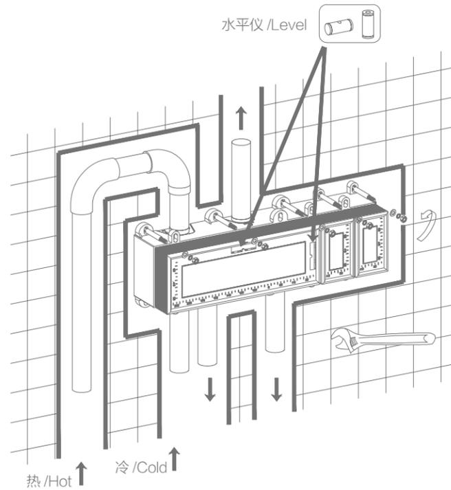
观察水平仪，确保水平安装
