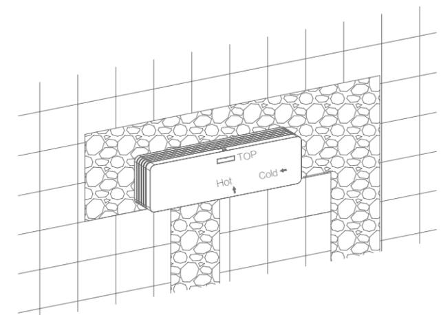
A. 面盆龙头预埋盒安装（有面板） | 空心墙体安装 HOLLOW WALL INSTALLATION
