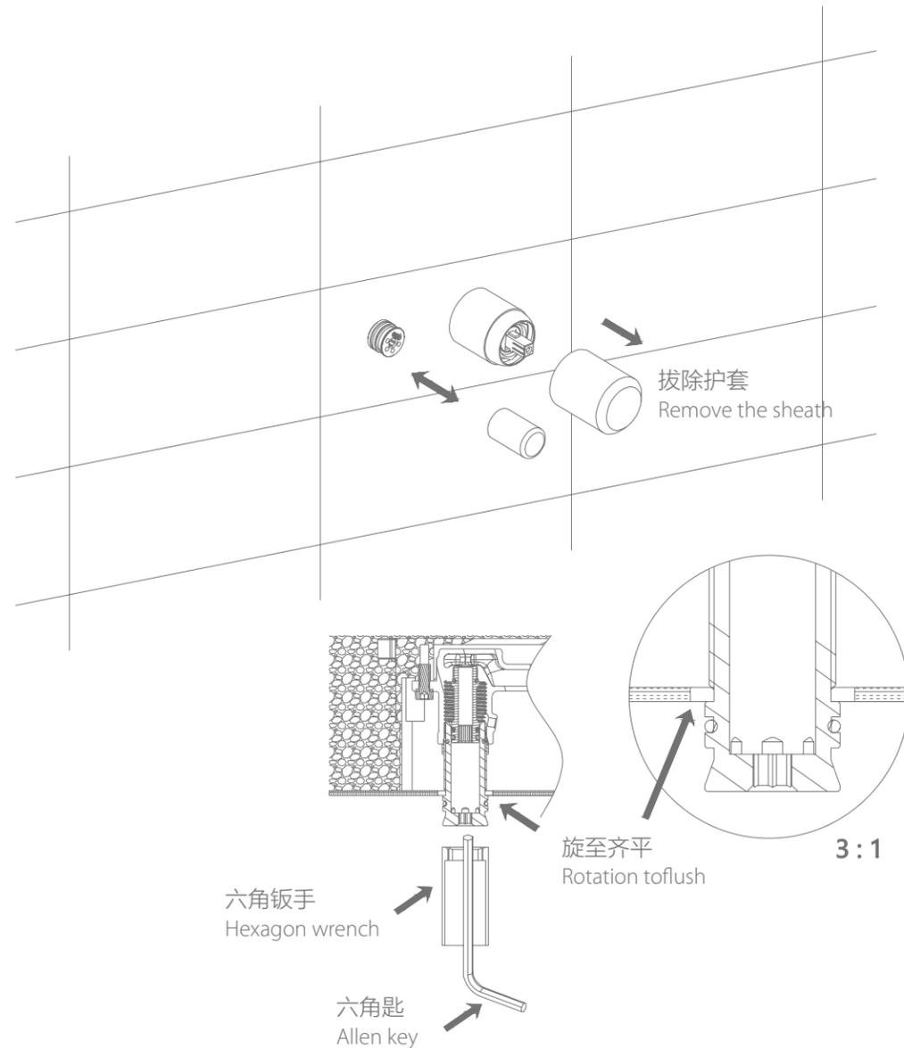
将接头旋入至指定的高度位置，再用六角匙配合六角扳手锁紧接头
