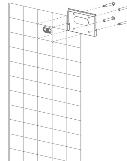
用膨胀螺丝拧紧墙上的固定板。
