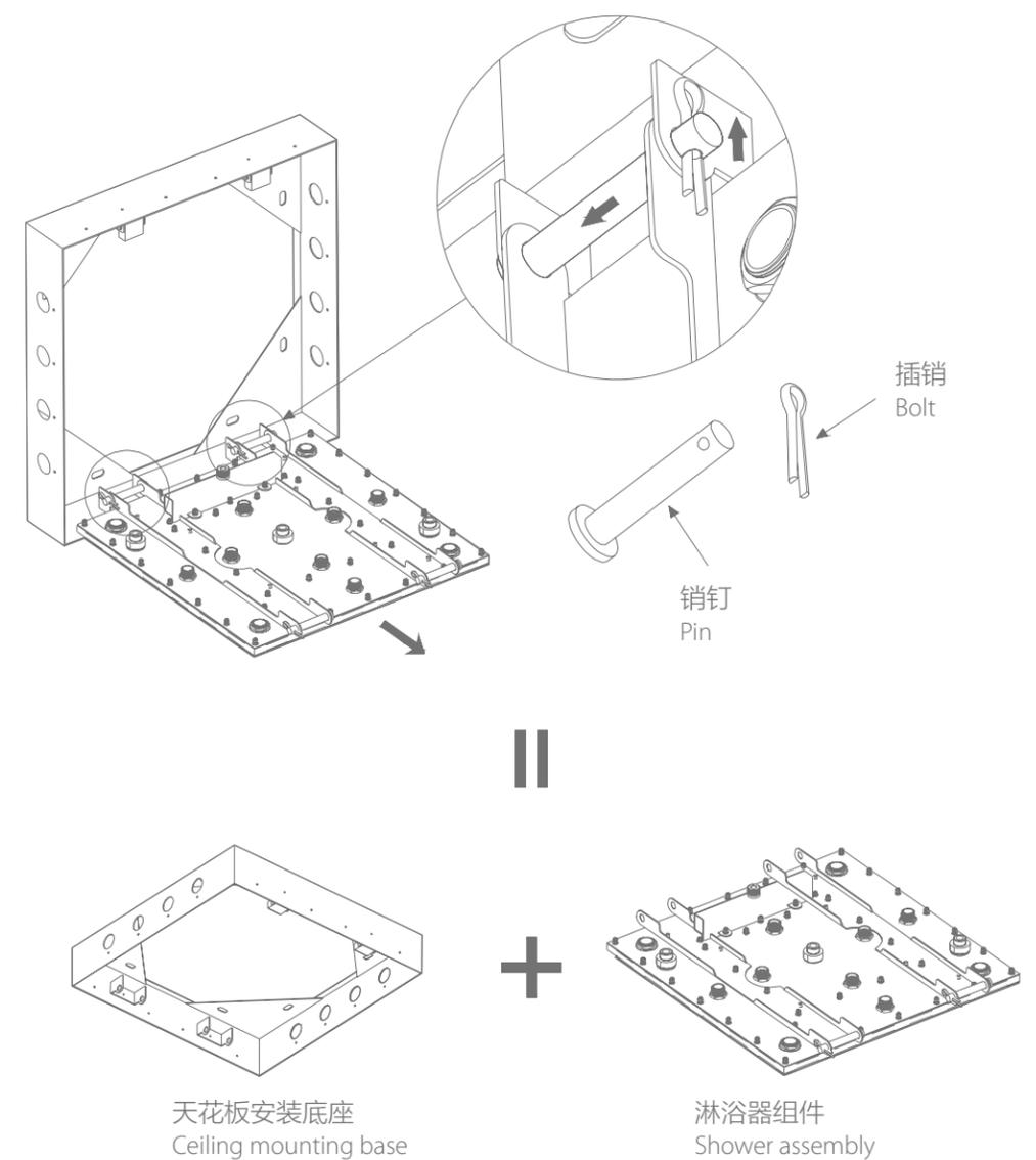
拔出插销，卸下销钉，分解出天花板安装底座和淋浴器组件
