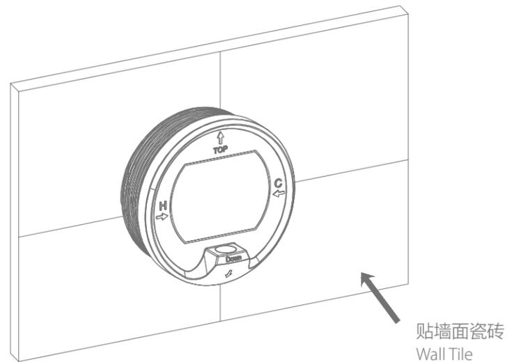
C. 控制阀安装 CONTROL VALVE INSTALLATION
