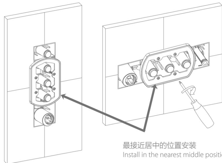
C. 控制阀安装 CONTROL VALVE INSTALLATION
