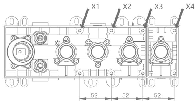
在预埋盒中选一组最接近居中位置的安装孔(4个孔)安装面板连接板, 务必注意: 面板与之是有匹配关系的。
