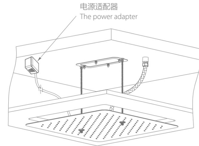
若选用灯光花洒，在固定花洒前，要通电测试，点亮灯光，确认电路正确接通
