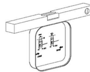
用平行尺测量预埋箱壳与垂直墙面的夹角及墙面平整度。如果墙面不平整，可以进行修补，保证预埋箱壳与垂直墙面的夹角接近理想的 90 度角，便于磁砖的装饰。
