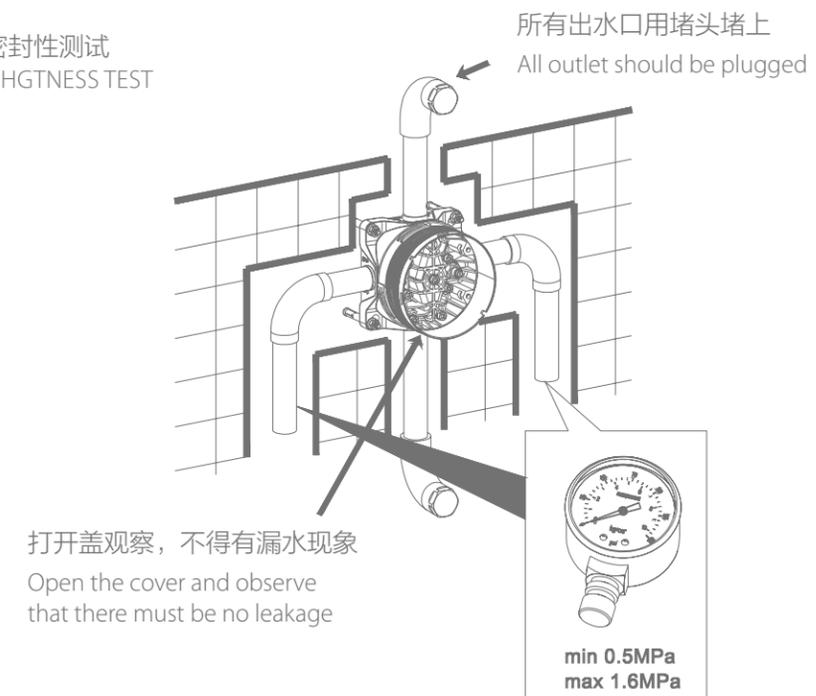
管道充水后, 向冷、热水两端施加水压, 仔细检查各接头处、管道不得有任何渗漏水现象。测试时长不小于 5 分钟
