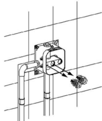
分别打开雨水阀和瀑布阀，冲洗管道内污物，以免堵塞，影响出水功能。
