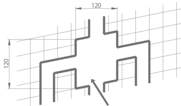
开孔深度 52-78mm, 最佳开孔深度 78mm
