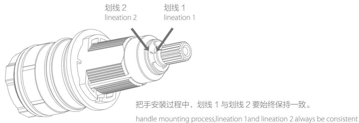
安装把手。把手安装过程中, 阀芯的花齿杆不能有任何角度的转动, 以确保把手安装后默认温度为 38° C。若过程中花齿杆不慎发生了角度转动, 则要根据阀芯的限位刻度线 (定位画线) 调好默认温度位置
