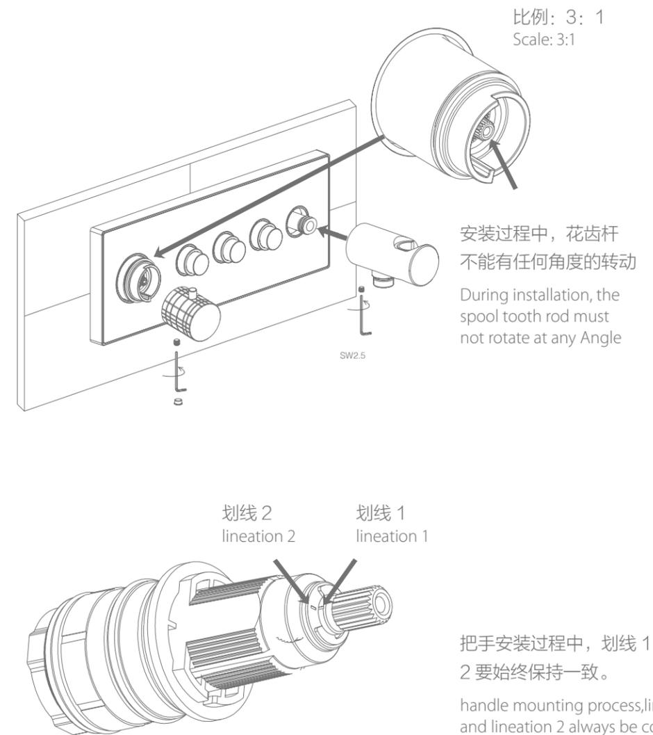
安装把手。把手安装过程中，阀芯的花齿杆不能有任何角度的转动，以确保把手安装后默认温度为 38° C。若过程中花齿杆不慎发生了角度转动，则要根据阀芯的限位刻度线（定位画线）调好默认温度位置。
