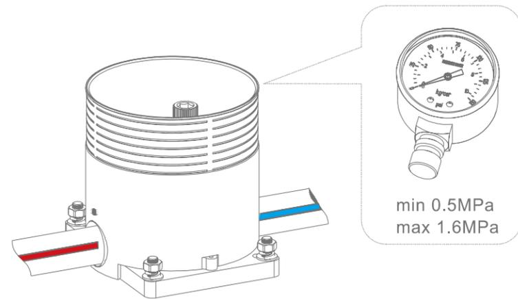
水平安装固定后, 进行密封性测试, 确保无渗漏
