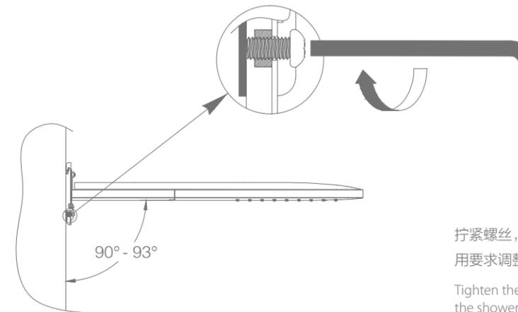
拧紧螺丝，承受固定板后，让淋浴器升起，根据使用要求调整角度。
