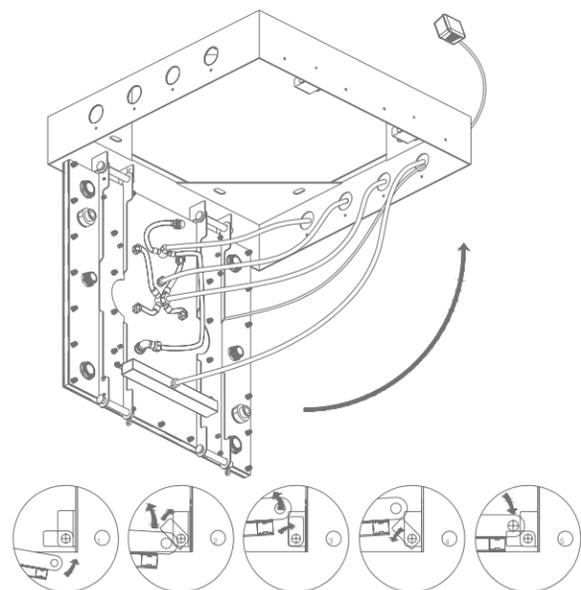
按照 1-5 的步骤用花洒主体完全顶起卡钩，然后放下，让花洒主体平稳挂钩在天花板安装底座上
