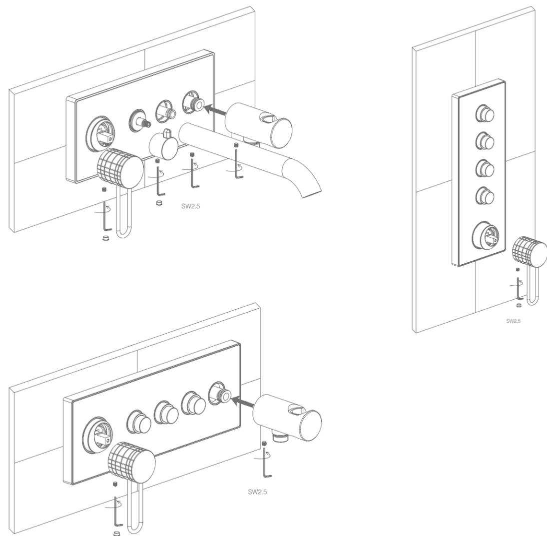
C. 控制阀安装 CONTROL VALVE INSTALLATION
