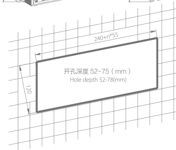
1.4 竖向安装墙面开孔尺寸
