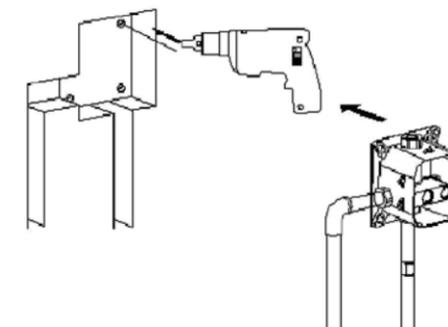
在开挖壁上钻 4 个固定孔（孔径不大于膨胀螺杆直径，孔位为预埋箱底部的 4 个固定孔）。
