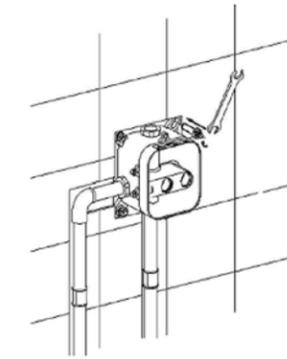
用膨胀螺丝将预埋的盒、管固定在开挖壁上，用六角扳手拧紧膨胀螺丝上的锁紧螺母，确保安装牢固。
