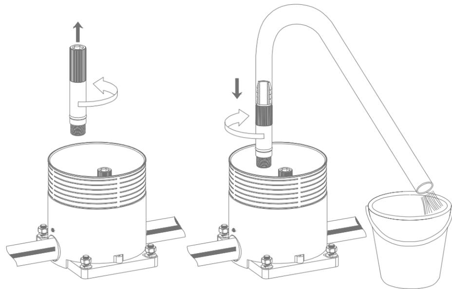
依次拧出堵头, 接上排水接头, 打开进水阀门, 将预埋盒内部通道冲洗干净
