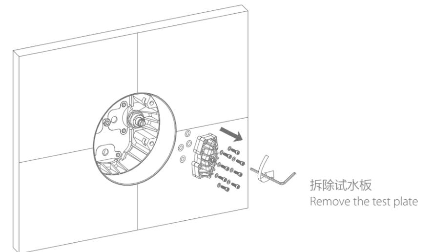
C. 控制阀安装 CONTROL VALVE INSTALLATION
