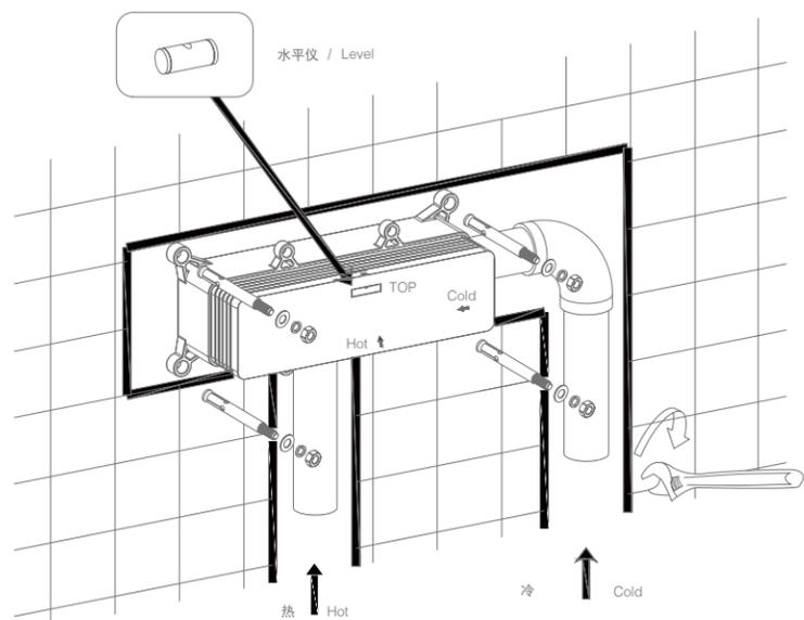
观察水平仪，确保水平安装
