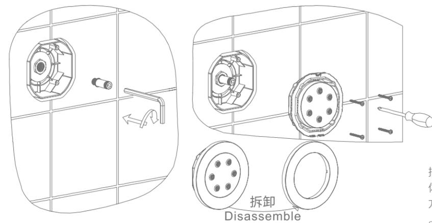
把连接杆旋在预埋座中间的孔位，再装上喷射主体，用四个螺钉固定好（本产品有两款，一款是方型，另一款是圆型）。
