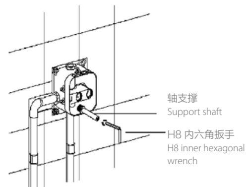
用支撑轴挡雨，打开雨水水源，检查各处密封和压力情况，确保无渗漏。
