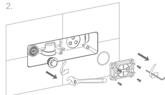
拆除试水板、试水接头
