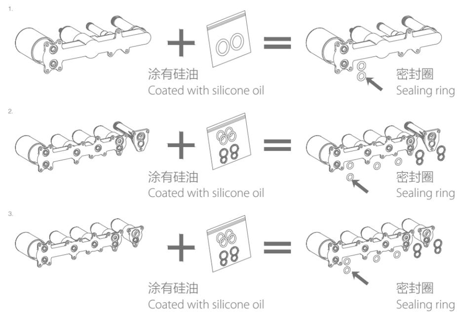
C. 控制阀安装 CONTROL VALVE INSTALLATION
