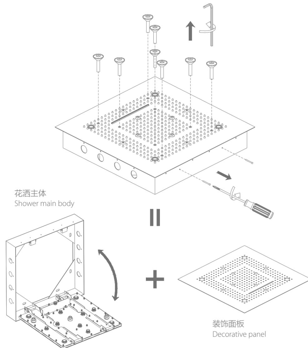
拧开面板螺丝和侧螺丝，分解出花洒主体和装饰面板
