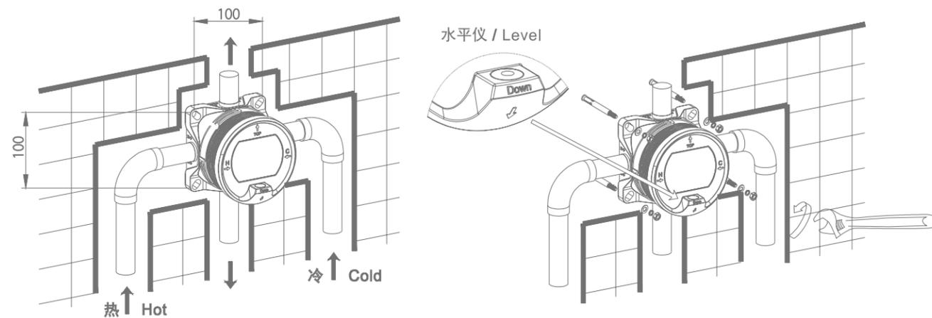
观察水平仪, 确保水平安装
