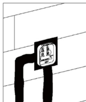
试水后确认无渗漏后，将纸卡盖好，防止异物进入预埋盒内，并用水泥填料将管道和预埋箱密封。
