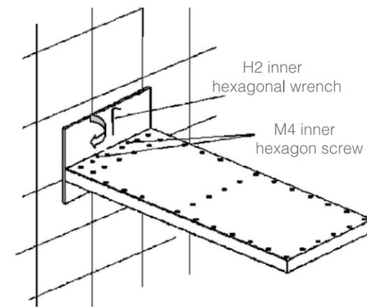
拧紧淋浴器后盖上的两根顶部电线，以防淋浴器滑落。到目前为止，安装已经完成。
