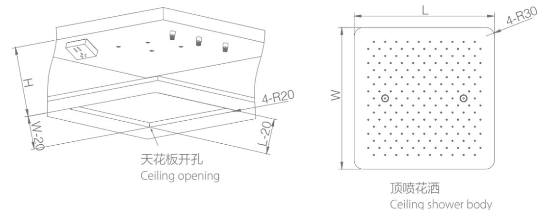
吊装天花时预留顶喷花洒开口尺寸，开口尺寸要比花洒尺寸小 20mm
