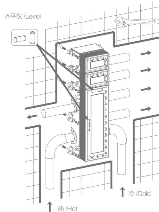
观察水平仪，确保水平安装
