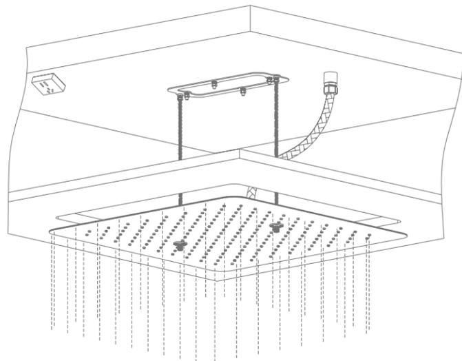
连接好软管后，打开开关阀，让产品处于正常使用状态，观察软管接头处，确保各软管接头无漏水现象
