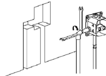
双功能喷头：将雨水管和瀑布连接管分别与预埋箱对应的接头连接，用扳手拧紧固定。
