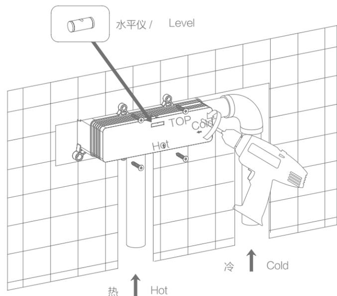
观察水平仪，确保水平安装
